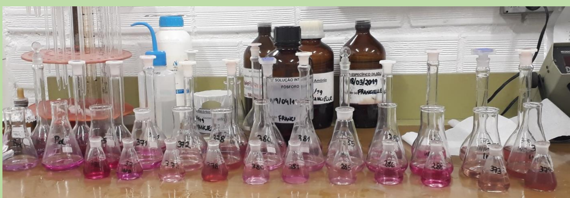
Figura 3: Determinação de Fósforo Total: Nesslerização com destilação prévia.
