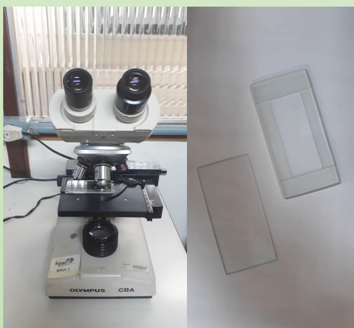
Figura 1: Microscópio óptico e câmara de contagem de Sedgwick-Rafter.
